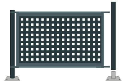
7. Dans le cas d'une fixation des poteaux sur platines, visser la platine au sol ou sur le muret puis insérer le premier poteau. Accrocher le panneau au poteau puis insérer le poteau suivant.
