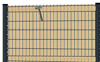
4. Fixez les lames sur les profils horizontaux au dos du panneau à l'aide d'une agrafe ou d'un clou.
